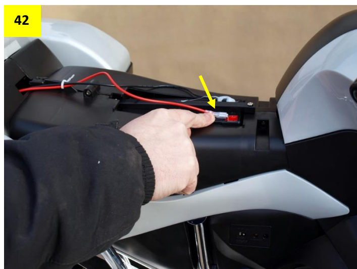
Obr. 42: Zapojte baterii. Červený kabel na červený (+) kontakt baterie. Černý kabel (-) už je zapojený z výroby.
