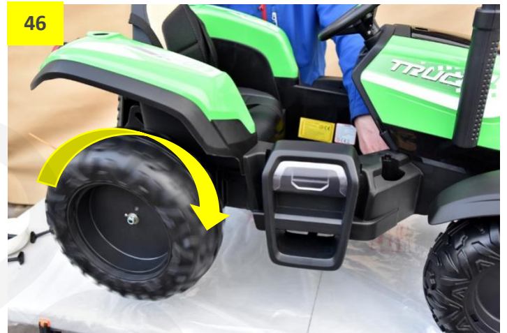
Obr. 47: Pokud se kola točí správným směrem, nasadte poklice. Výstupky v poklici zatlačte do otvorů v kole.
