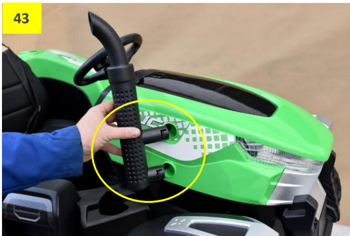
Obr. 45 a 46: Nasazení poklic kol – než nasadíte poklice kol, zapněte vozítko, stlačte pedál a zkontrolujte, zda se kola točí správným směrem vpřed a vzad.
