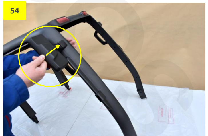
Obr. 54: Zpětné zrcátko nasadte a zatlačte nadoraz do otvoru rámu střechy.
