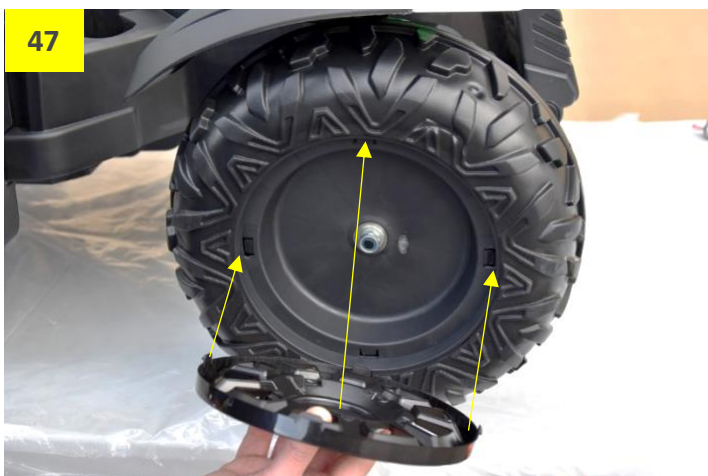
Obr. 48: Poklici zatlačte nadoraz do kola.
