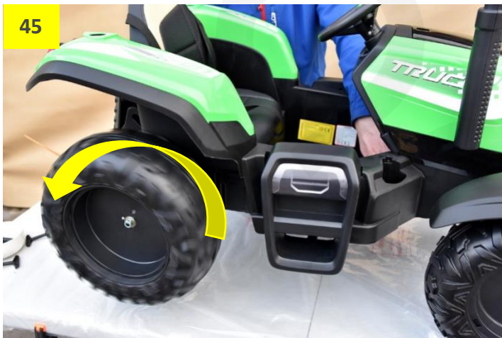
Obr. 47: Pokud se kola točí správným směrem, nasadte poklice. Výstupky v poklici zatlačte do otvorů v kole.
