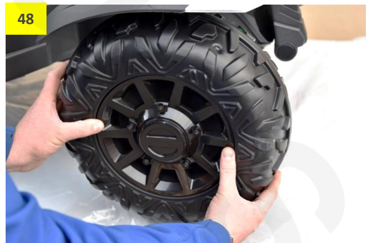
Obr. 47: Pokud se kola točí správným směrem, nasadte poklice. Výstupky v poklici zatlačte do otvorů v kole.
