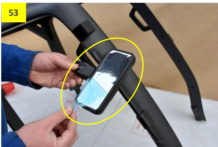
Obr. 54: Zpětné zrcátko nasadte a zatlačte nadoraz do otvoru rámu střechy.
