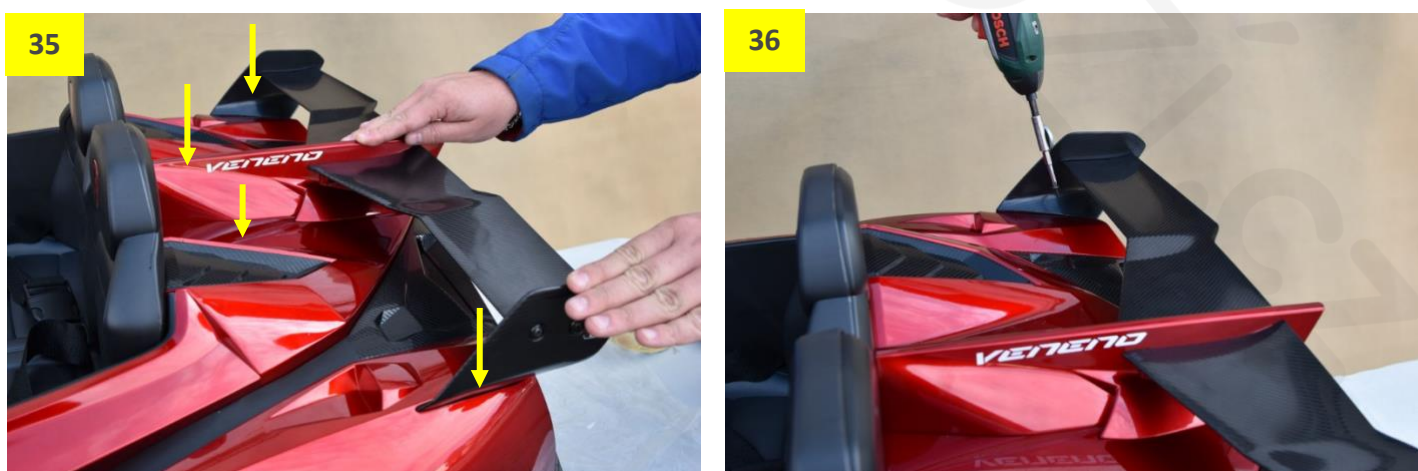
Obr. 35 a 36: Křídlo zatlačte nadoraz do otvorů v karoserii a přišroubujte.
